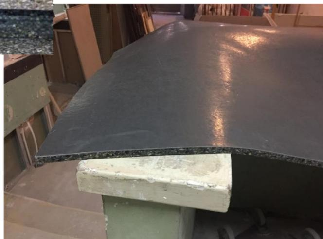
Es efectivo en BAJAS FRECUENCIAS, aumentando su efecto, tanto mayor cuanto más espesor. En las cavidades ó poros se produce una disipación de energía por viscosidad. (Este es el funcionamiento de Elastómero Arkobel con Lámina Acústica).
