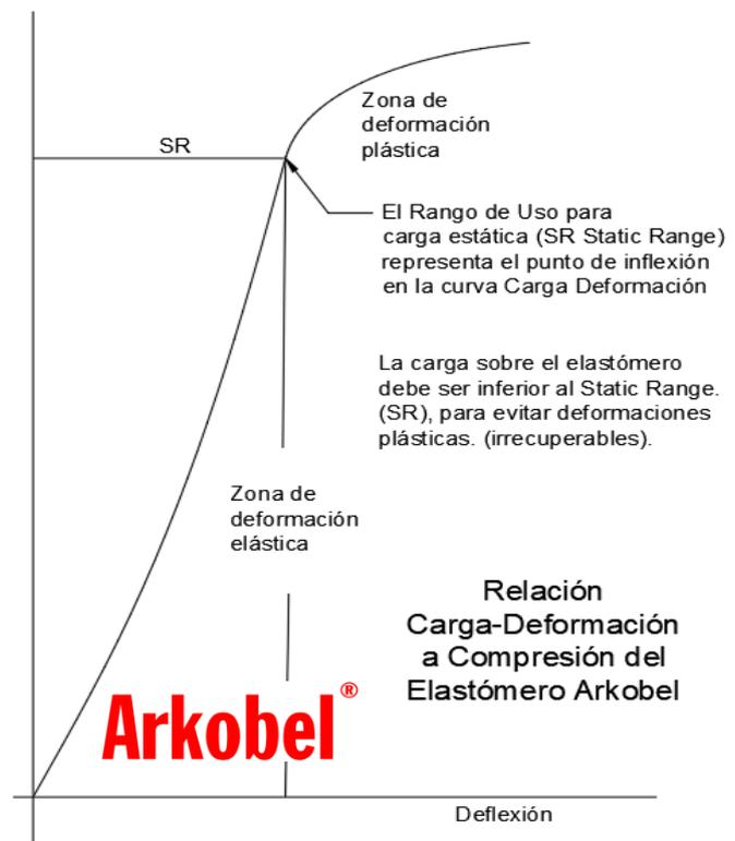
Por encima del Rango de Uso para Carga estática hay un cierto porcentaje de deformación plástica. (No se recupera al cesar la carga). Conviene no superar éste límite. Esta es la razón de escoger el Elastómero con la SR (Static Range) adecuada.
